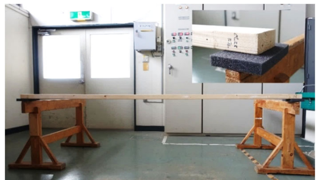
写真2 試験体の設置
