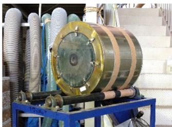
写真7 混合機（少量試験用）
