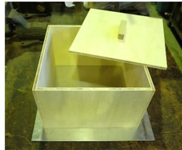
写真9 フォーミング用型枠と押さえ板
