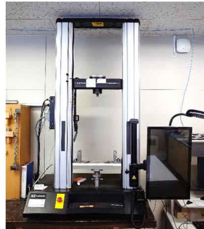
写真14 インストロン型万能強度試験機
