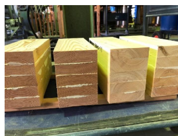
写真4 集成材の完成。 このあと養生してから、浸水、 乾燥させる
