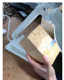
写真5 接着層を一つ一つ確認 し、はく離を測定
