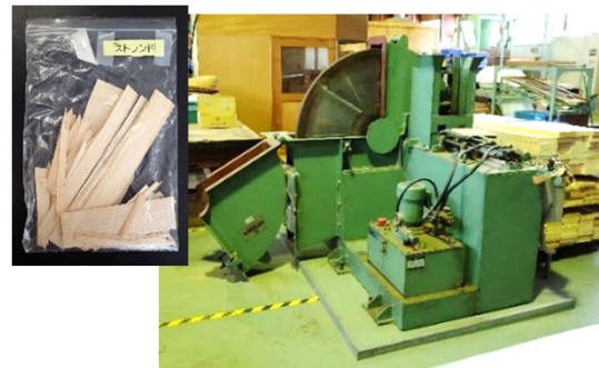
写真2 シェービングマシン 左上は粉碎物のサンプル
