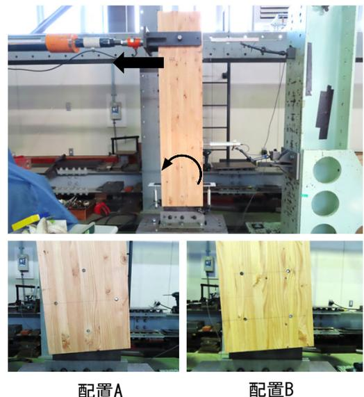
図7 モーメント抵抗接合部の加力試験
