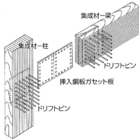
図5 鋼板挿入ドリフトピン接合<sup>3)</sup>
