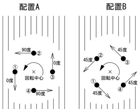
図9 各ドリフトピンのめり込み方向
