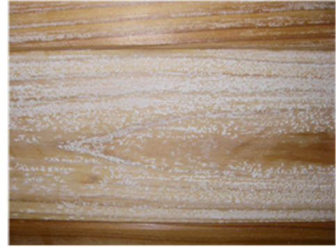
写真1 難燃薬剤処理木材に発生した白華の一例
