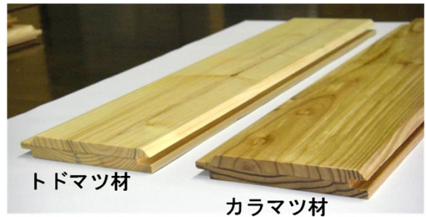
写真3 開発した難燃薬剤処理木材の外観(準不燃材料仕様)
