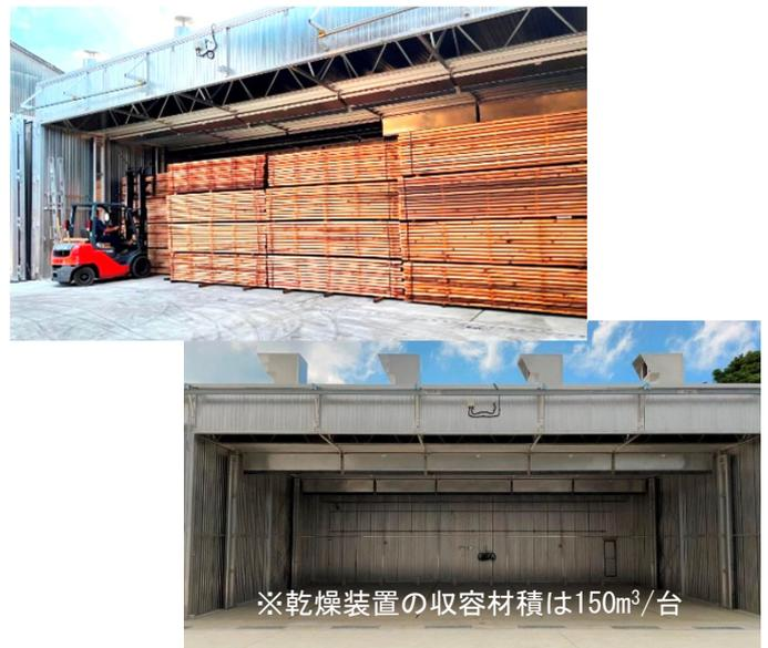
写真1 大型の蒸気式乾燥装置の設置事例 (提供：エノ産業(株))
