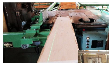
写真4 レーザー光線で切削をガイド
