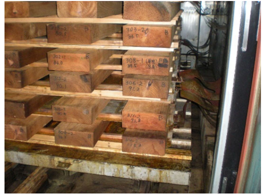
写真2 蒸気高周波複合式乾燥装置内部 (栈積み数段ごとにアルミ製の電極板を挿入する)
