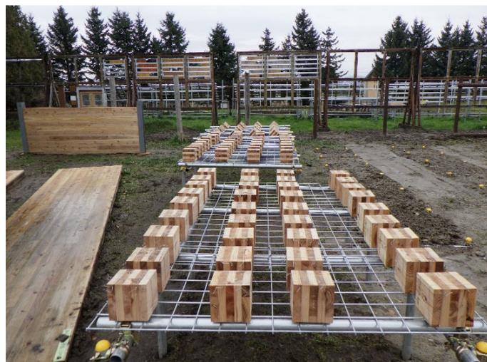
図5 屋外暴露試験中のCLT試験体
