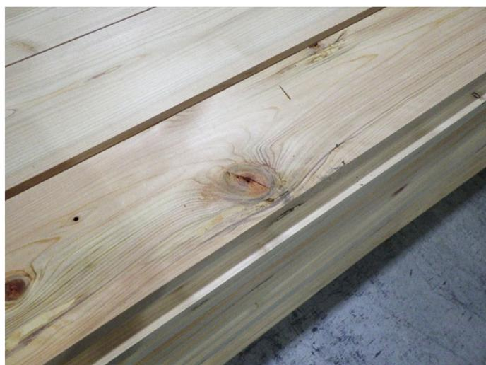
図4 低質材料の例(節および腐れ、変色)
