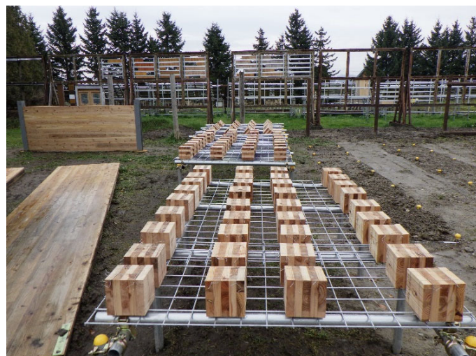
図5 屋外暴露試験中のCLT試験体
