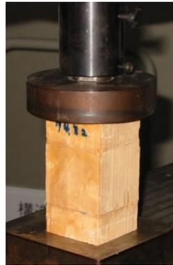
図1 木材の縦圧縮試験の様子
