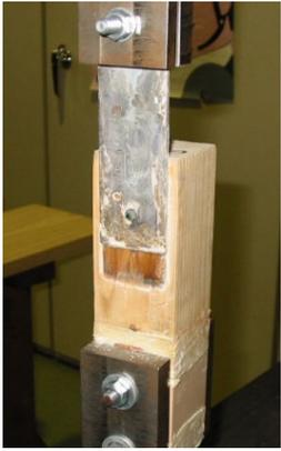
図3 釘接合部の一面せん断試験の様子
