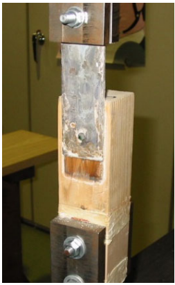
図3 釘接合部の一面せん断試験の様子
