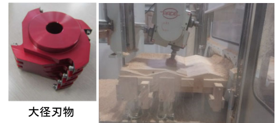
図4 5軸式加工機によるブロックの加工
