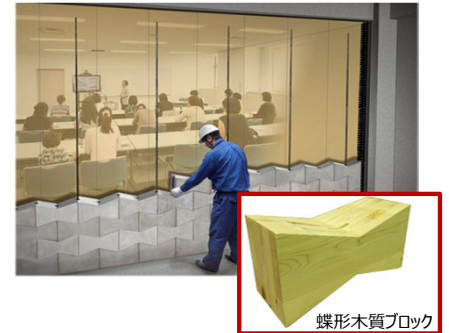
図1 蝶形ブロックによる補強工法
