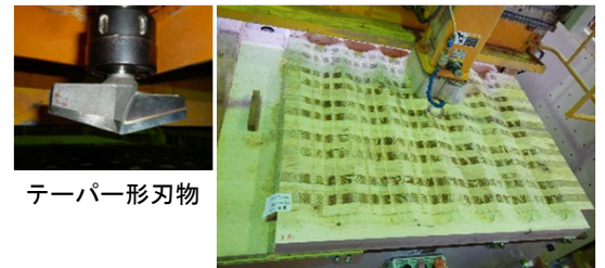
図3 3軸式加工機によるブロックの加工
