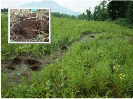
写真2 試験地（京極町） 地表から30cm下まで黒土（左上） 土壌硬度15mm程度（柔らかい）
