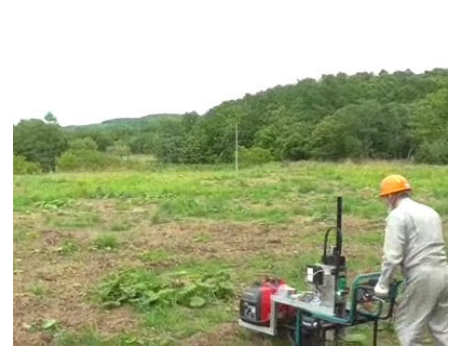
写真4 試験地（美唄市） 重機で踏み固められていた 土壌硬度25mm程度（硬い）
