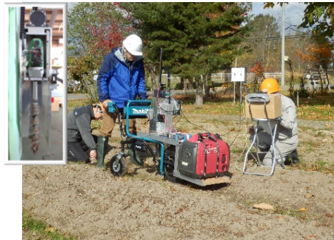
写真5 試験風景（美唄市） 左上は使用したドリル（直径60mm）
