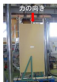
図4 鉛直載荷試験 (幅0.9m×高さ2.4m)
