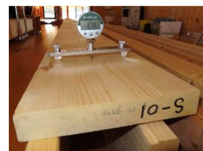
図6 床根太材の反りの測定 (幅38mm×材せい235mm)
