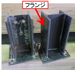
↑ H形鋼のフランジ(両脇のリップ)による接合部の回転剛性UPを狙って設計した柱脚接合金物
