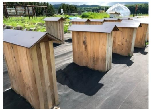
図3 CLTによる土木構造物を想定し、経年変化を把握。地上部と同じ長さが地中に入っている
