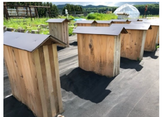
図3 CLTによる土木構造物を想定し、経年変化を把握。地上部と同じ長さが地中に入っている （写真のCLTは薬剤の処理はしていない）
