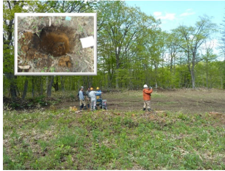
写真3 試験地（池田町） 地表から10cm下は粘土質（左上） 土壌硬度20mm程度（やや硬い）
