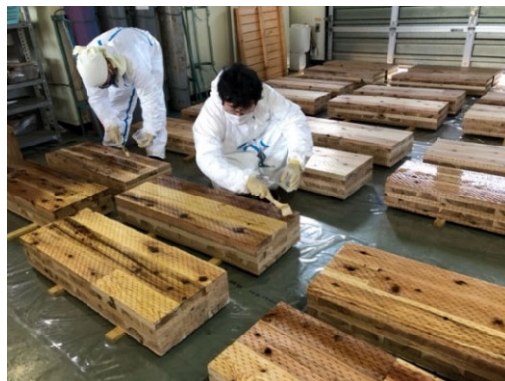
図2 CLTにインサイジングを施し、薬剤を浸透させた試験体づくり
