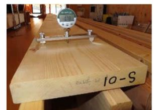
図6 床根太材の反りの測定
