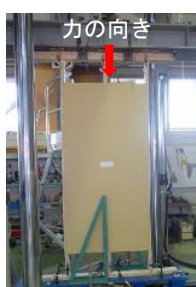
図4 鉛直載荷試験 (幅0.9m×高さ2.4m)
