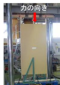
図4 鉛直荷重試験
