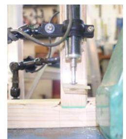
図5 下枠材のめり込み
