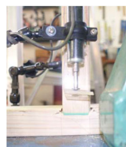
図5 下枠材のめり込み
