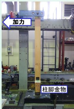
2/3P<sub>max</sub>(最大耐力の2/3)とP<sub>y</sub>(降伏耐力)のうち最も弱い値を用いて判定→
