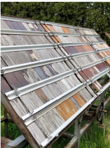
図1 塗装、薬剤処理をした木材を屋外に設置して経年の変化を把握
