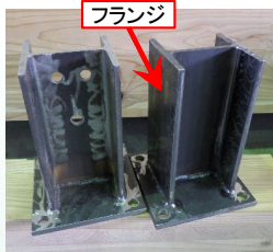
↑ H形鋼のフランジ(両脇のリブ)による接合部の回転剛性UPを狙って設計した柱脚接合金物
