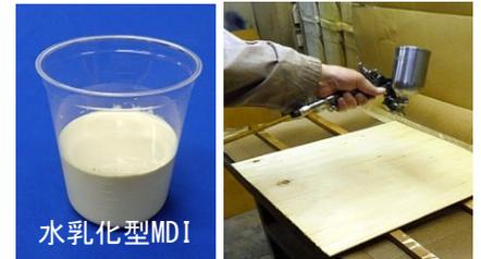
図1 エアスプレーによる接着剤の塗布
