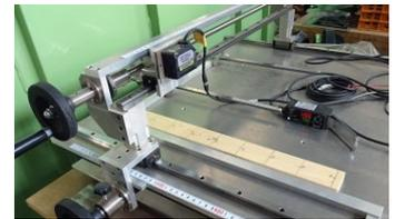
図2 反り量の測定
