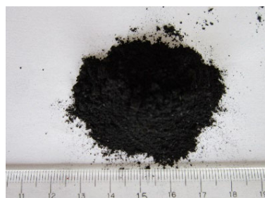
ガス化副産物の外観
