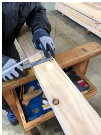
図2 節の場所と大きさを測定
