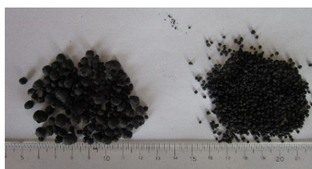
ガス化副産物を用いた造粒物の一例
