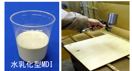
図1 エアスプレーによる接着剤の塗布
