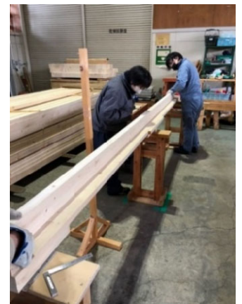
図4 林産試験場オリジナルの計測台で、曲がり、反り、ねじれをいっぺんに測定
