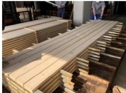
写真1 実際の工場と同様に製材した板を一つ一つ積み重ねて乾燥試験を実施
