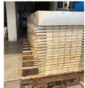
写真2 積積みした木材に重しを載せ、乾燥機(収容材積5m<sup>3</sup>)で乾燥した後、含水率やねじれ、曲がりなどのデータを計測
