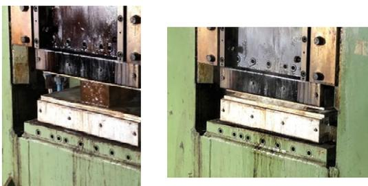
ホットプレスによる圧縮。(左:圧縮前, 右:圧縮後) 原材料の特性をとらえ用途に適した厚さに仕上げる。
