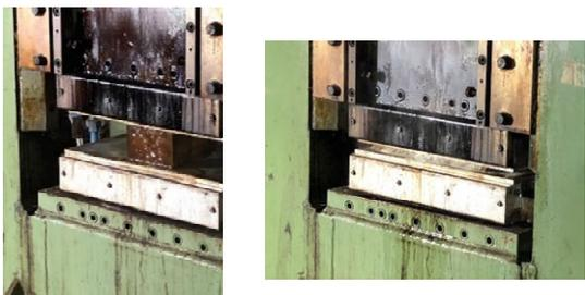
ホットプレスによる圧縮。(左:圧縮前, 右:圧縮後)
