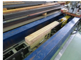
引張強度試験 手前が測定対象の接合金物、奥側が治具。
