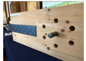
引張試験の試験体
