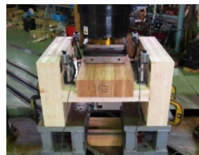
床と壁の接合部の 垂直荷重試験
