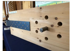
引張試験の試験体 手前が治具側で、7カ所の穴あけが必要。
