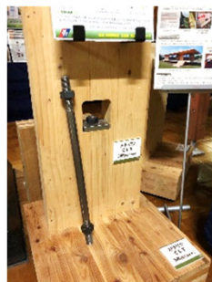
接合方法の一つ「引きボルト」。たてかけてあるボルトをCLT内部に入れる長い穴が必要。
