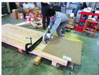
CLTのマザーボードから試験体を切り出す。写真は厚さが90mmのため1回で切断。
