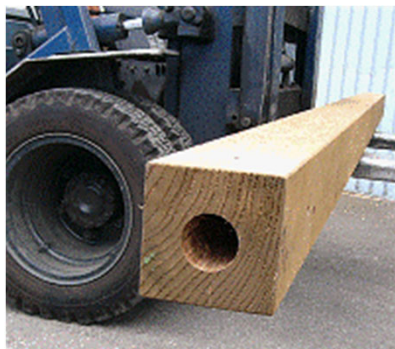
写真2 支柱下端の開口
