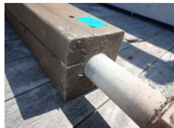
写真15 柱脚部の状態 (処理木材) (左:スギ, 右:トドマツ)
