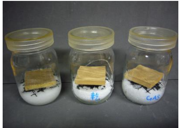
図3 滅菌による変色防止効果の確認 (相対湿度90%) 無処理(左) 乾熱処理(中央) GAS滅菌(右)
