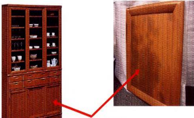
図1 食器棚の扉に発生した変色
