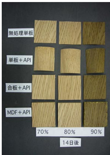
写真2 調湿条件による変色の有無 (使用接着剤APIの例)
