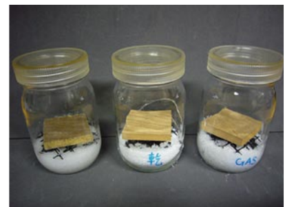
写真4 培養瓶を用いた試験片の変色試験
