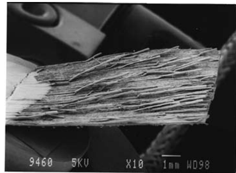
図2 道管内で硬化した接着剤の電子顕微鏡写真
