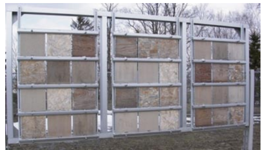
写真 1 旭川での屋外暴露試験風景
