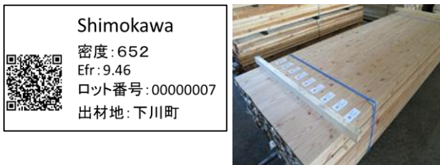
図2 左図：製品に貼付する生産履歴情報ラベル 右図：ラベルを貼付した出荷前の製材
