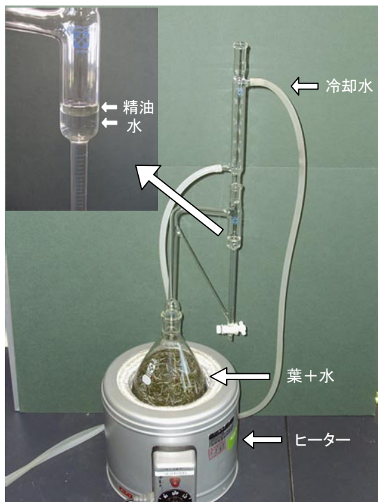
図 実験室レベルでの精油の採取（熱水蒸留法）
