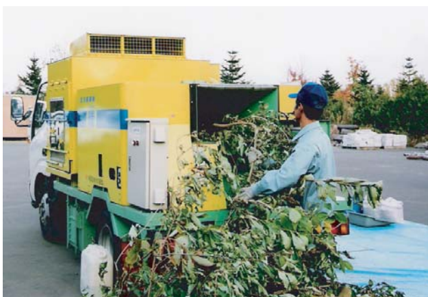
写真1 回転式圧縮・混練装置による剪定枝の粉碎
