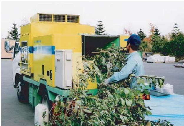
写真1 回転式圧縮・混練装置による剪定枝の粉碎
