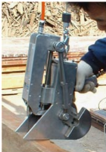
写真1 開発した釘抜き装置
