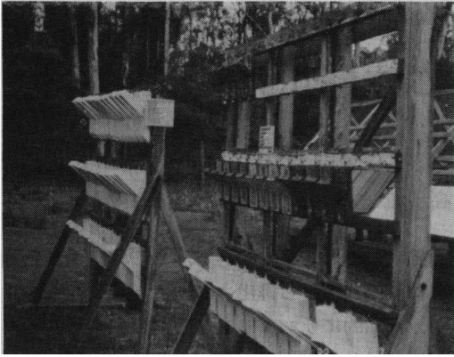
窓枠など非接地部材の暴露試験
