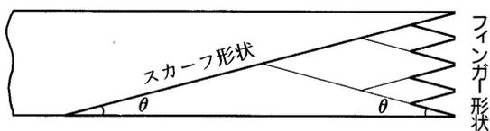
図1 スカーフ形状とフィンガー形状の比較
