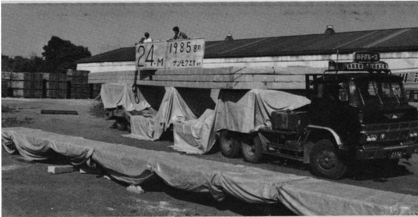
一本のものとしては我が国最大の集成材の大型トレーラーへの積み込み風景(砂川市 サンモク工業にて)
