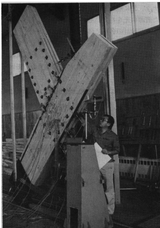
軒肩部の強度試験（林産試験場）
