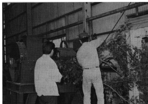
刃物と粉碎機の組み合わせのオガコマシーン
