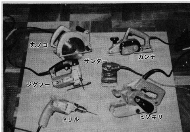
写真2 電動工具の種類
