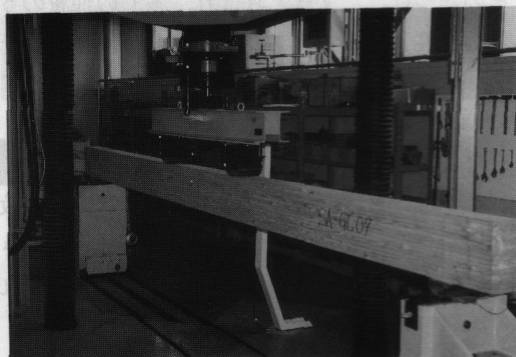
写真5 構造用大断面集成材の曲げ試験
