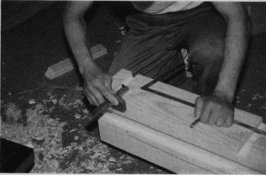
写真 1 軸組およびパネル部材の加工
