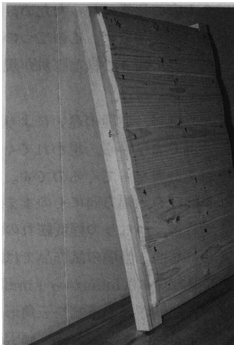
写真3 トドマツ 含水率19%のふくれ状態
