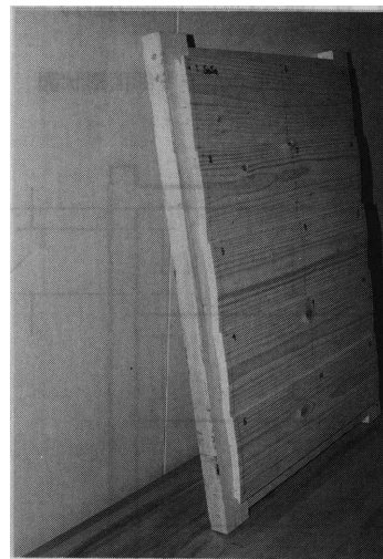
写真5 トドマツ 含水率19%の よろい下見時のふくれ状態
