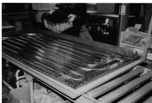
写真3 成型中の床暖房パネル
