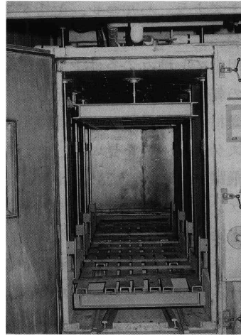
写真4 乾燥機内の圧縮プレス
